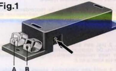
Der **Aufenthaltsschalter 6953** ist ein thermisches Verzögerungsrelais, das die Fahrspannung in einem einstellbaren Rhythmus zu- und abschaltet. Die Schaltzeit ist von der Stromaufnahme der Lokomotive abhängig und lässt sich mit der Stellschraube (siehe Pfeil Fig. 1) zwischen ca. 3 und 60 Sekunden einstellen. Bei Rechtsdrehung kürzere, bei Linksdrehung längere Schaltzeit.
